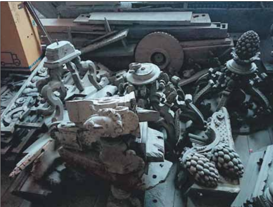
Elementy aparatu gry (w tym kłoce, ławeczki i napęd Zimbelsternu) i spływy. P. Lewko, 2024
