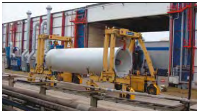
GSG towers oddział Grupy Przemysłowej Baltica na terenie Stoczni Gdańskiej produkuje kolumny wież turbin wiatrowych. Fot. M. Głóskiewicz
